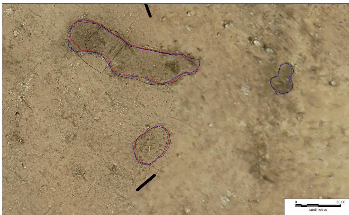
Figur 23. Serie 2 zoomniveau 2. Forskellen på modeller baseret på flyvning i 20 m's og i 3m's højde. Arealet på venstre side af de tykke sorte streger er baseret på 3 m's flyvning.
