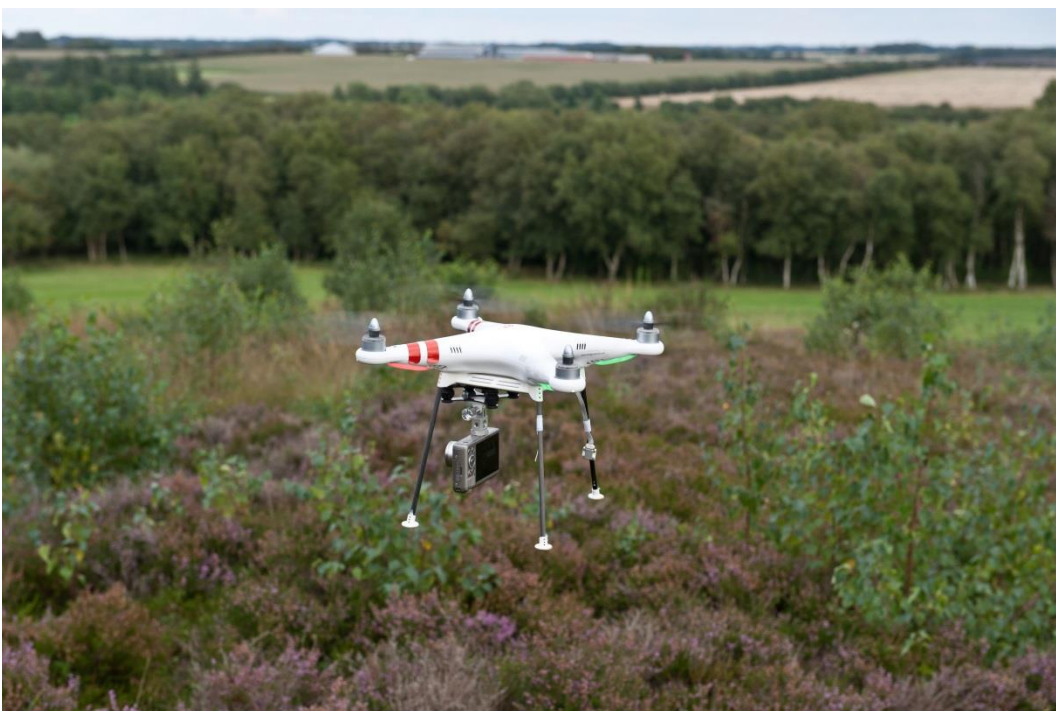
Figur 8. Ombygget Phantom 1, bemærk Canon kompakt kamera med 'customized' ophæng. Foto Lars Chr. Bentsen.
