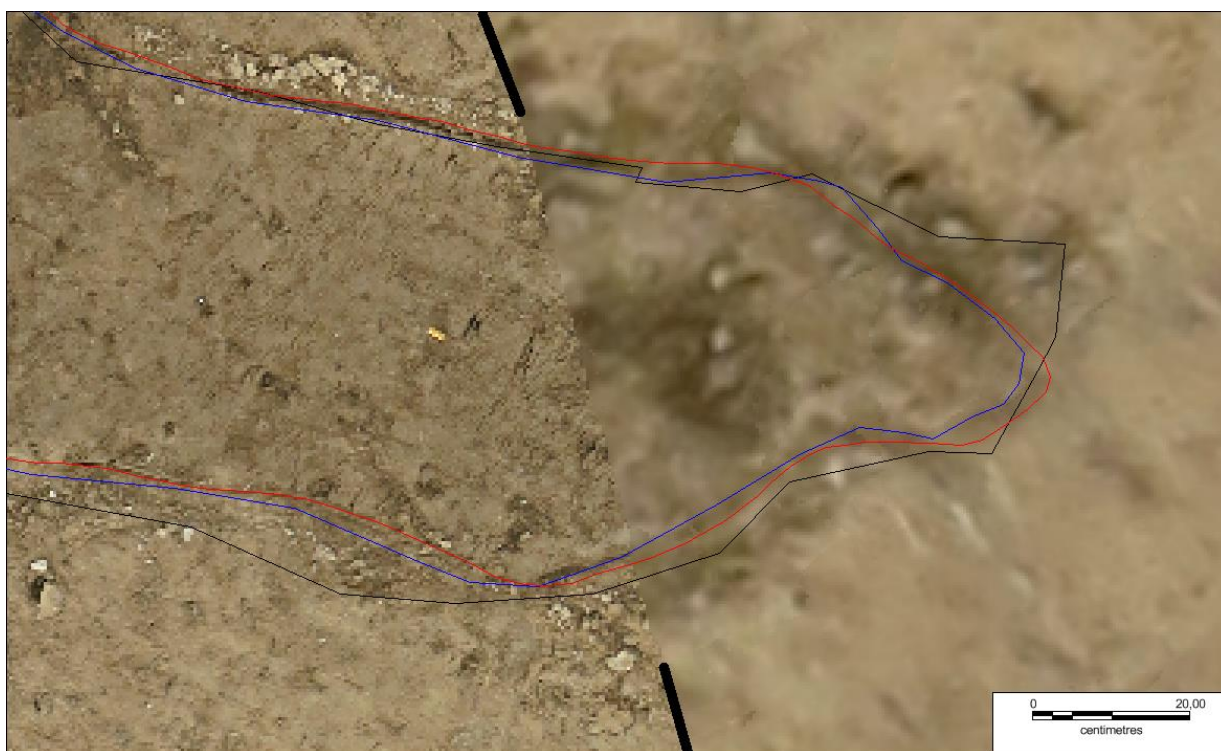
Figur 25. Serie 2 zoomniveau 4. Forskellen på modeller baseret på flyvning i 20 m's og i 3m's højde. Arealet på venstre side af de tykke sorte streger er baseret på 3 m's flyvning. Når vi er inde på dette niveau, begynder man virkelig at kunne se forskellen mellem de to flyvehøjder.
