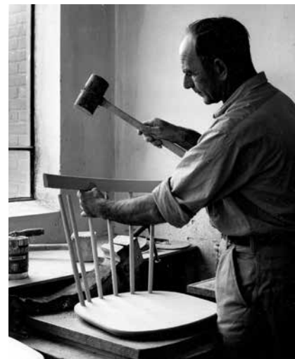
En medarbejder i gang med at montere ryglæn på en J77 eller J46.
