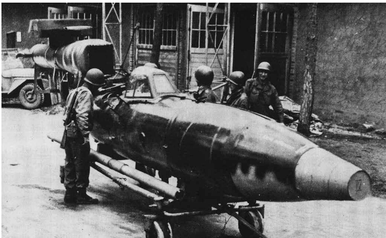
Et Reichenberg-selvordsfly inspiceres af amerikanske tropper i 1945. Der blev fremstillet 175 stk., men ingen blev nogensinde sat ind i kamp. Der blev gjort plads til piloten ved at fjerne sprængladningen. 18
