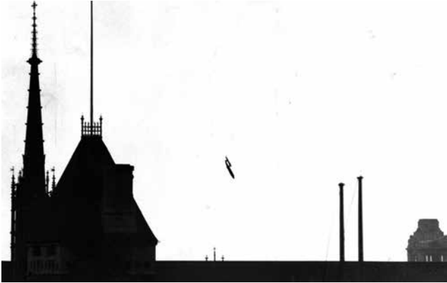
Efter at en lille propel i spidsen har drejet rundt et forudbestemt antal gange, slukker motoren, og V-1'eren styrtdykker. Det var dette øjeblik, hvor lyden af den pulserende motor stoppede, som englænderne frygtede. Foto: Associated Press. 3
