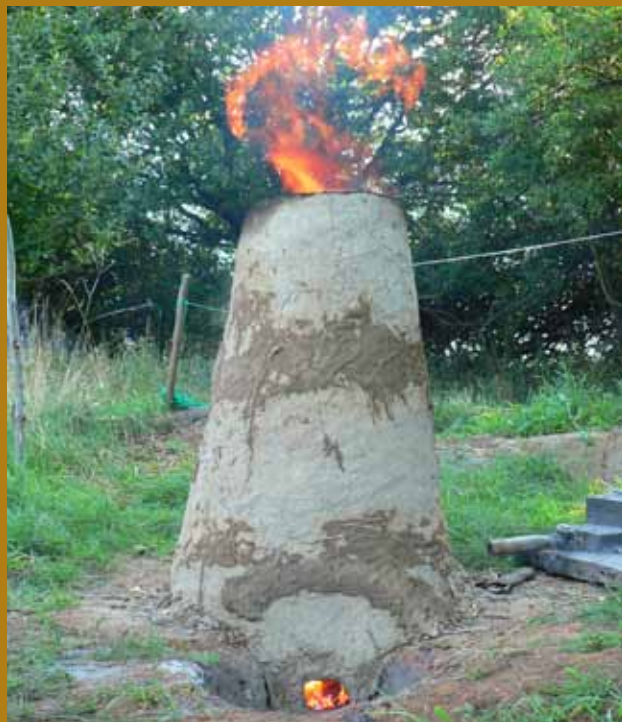
Jernudvinding i slaggeaftapningsovn ved forsøg i Lejre i 2009. Foto: Henriette Lyngstrøm.
