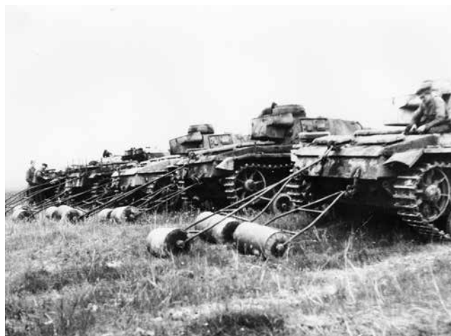
Kontrolkørsel med tyske kampvogne. Rydningen foregik ved, at køretøjerne kørte ind i minefeltet først med det højre bælte, mens det venstre var i minefrit terræn. Kampvognene trak nu tre svære ståltromler (fremstillet på Varde Stålværk), og disse detonerede nu de miner, der fandt sig i området mellem de to bælte. Foto: Blaavandshuk Lokalhistoriske Arkiv.
