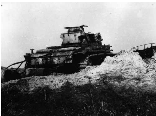
En Panzer III på kontrolkørsel på Skallingen. Denne form for rydning af panserminer var ikke ufarlig, men på den anden side heller ikke livsfarlig. Eksplosionerne kunne undertiden være så kraftige, at det kunne slå føreren af køretøjet bevidstløs, og han kunne pådrage sig nogle kvæstelser. Foto: Blaavandshuk Lokalhistoriske Arkiv.
