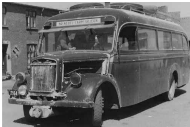
Samme bus, nu fotograferet i 1945 efter turen til Neuengamme. Udstyret foran køleren og under motoren hører til gasgeneratoren.
