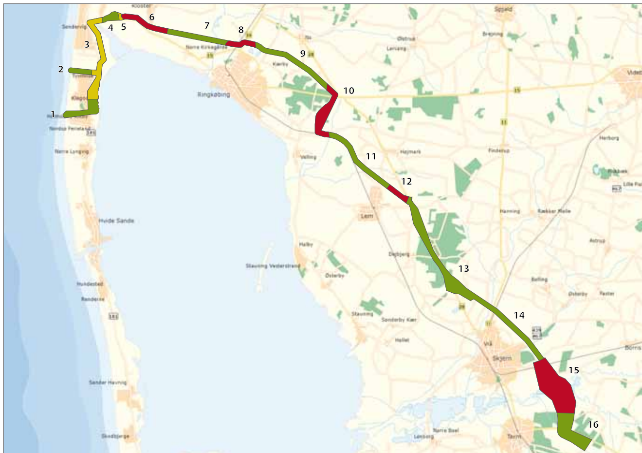
Projektområdet med risikomarkeringer. Grøn: kategori 1 – lav risiko; gul: kategori 2 – mellem risiko, rød: kategori 3 – højrisiko.
