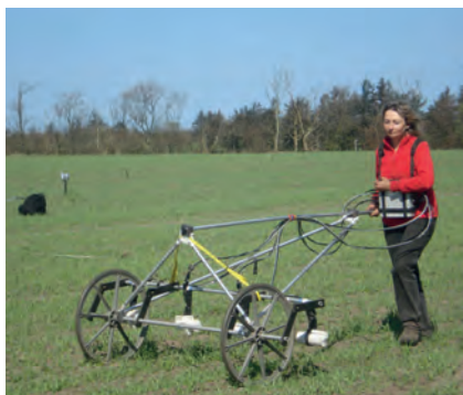
Magnetisk kortlægning af Kløvgårde. De fire sensorhoveder der er monteret på vognen måler jordens magnetfelt. Hvor der f.eks. er grube-huse, grave, brønde eller andre forstyrrelser, ses de tydeligt på kortene.
