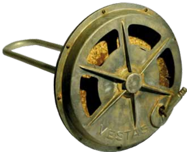
Den lille mælkekøler er et typisk Vestasprodukt fra årene før vindmøllerne. Køleren placeres som låg på en mælkejunge og sluttes til den kolde hane. Vandets går gennem bøjljen, idet det samtidig drejer den rundt. Derefter løber vandet ned over jungens sider og køler endnu en gang. Som man kan fornemme på billedet, sidder der en lille mølle inde i konstruktionen...
